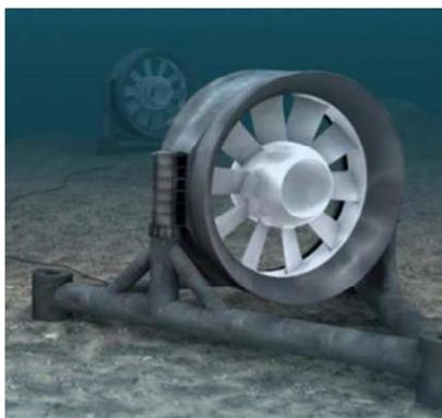
Cette énergie nécessite la mise en place d'une turbine sous-marine qui utilise l'énergie cinétique des courants marins pour créer une énergie mécanique transformée ensuite en électricité par un alternateur.
