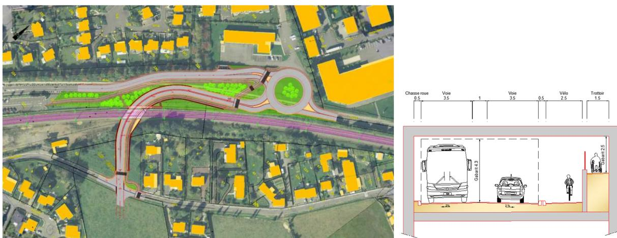
Figure 53 : Possibilités de trémie sous la voie
