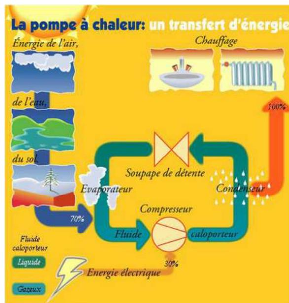
Figure 63 : principe de fonctionnement des pompes à chaleur (source [www.airclim-concept.com](http://www.airclim-concept.com))
