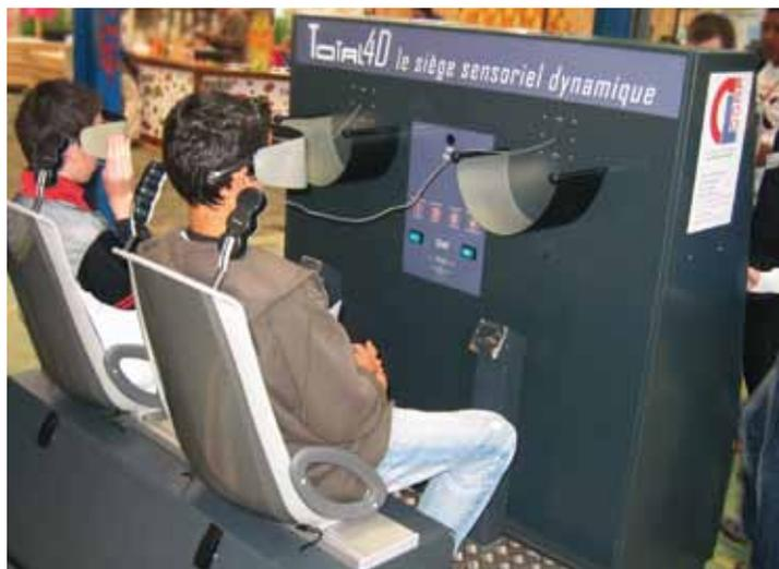
Équipés d'électro-aimant, ils se proposent d'offrir une « expérience 4D » aux spectateurs. Le siège réagit à des commandes programmées en parallèle du film projeté. Il peut tanguer, tourner, vibrer ou encore s'incliner légèrement selon l'action à l'écran. La synchronisation des mouvements des sièges au rythme des images vous donnera une impression saisissante de réalité.
