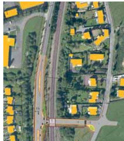
La variante 2 consiste en la mise en place d'un carrefour à feu.
