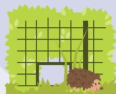
Réaliser un passage d'une hauteur de 8 cm pour la petite faune au ras du sol.
